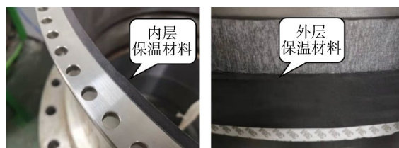
图 10 实验段内外表面保温材料
